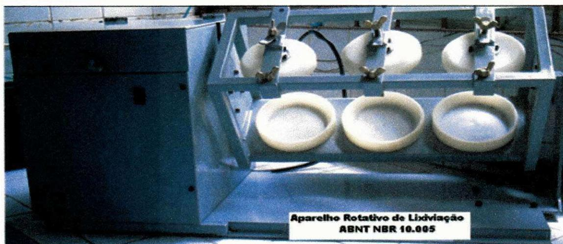
FIGURA 4: Aparelho Rotativo de Frascos para Lixiviação
