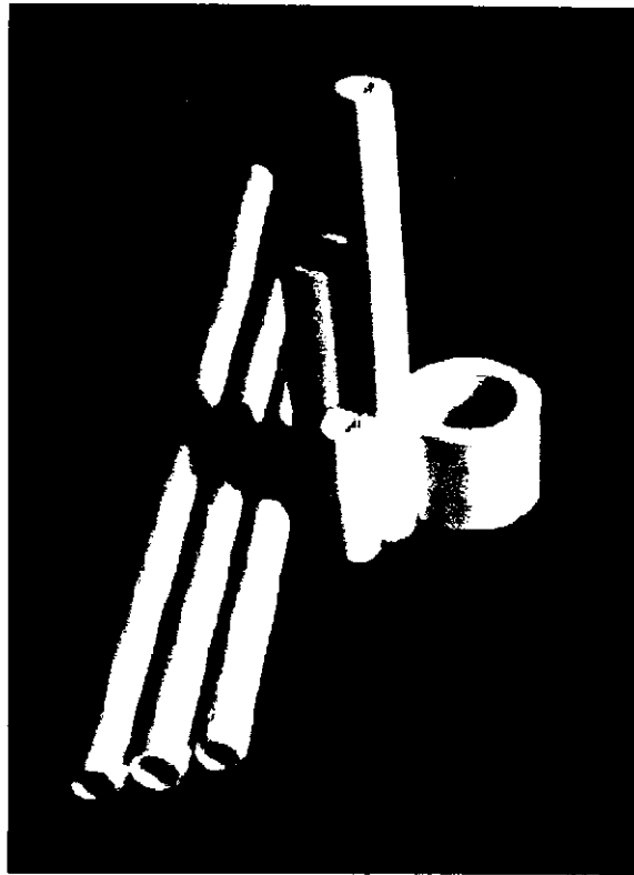
Figura 2.4 - Ilustração das membranas tubulares de alumina [42].
