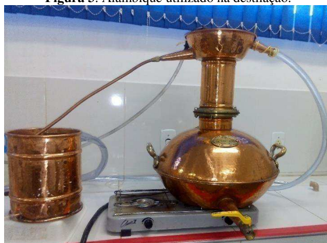
Figura 3. Alambique utilizado na destilação.
