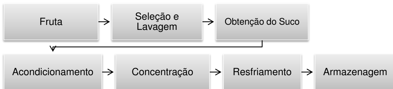
Figura 3: Fluxograma do processo do suco de abacaxi integral concentrado.
