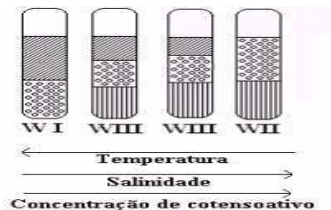
Figura 17- Sistemas de Winsor em função da temperatura, salinidade e concentração de cotensoativo. (Oliveira, G. S,2011).
