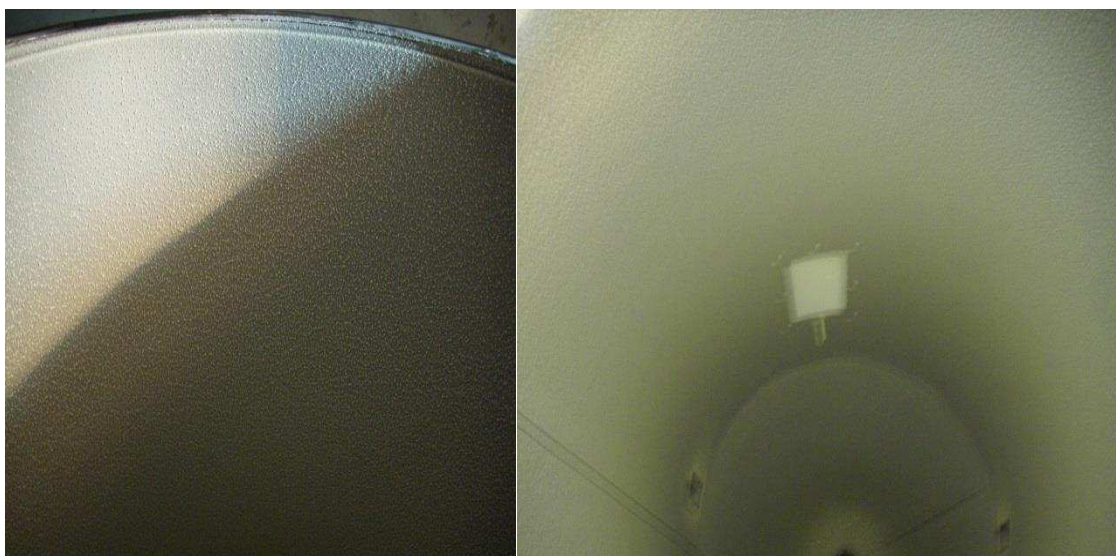
Figura 1 - As gotículas do leite quando não estão suficientemente secas.
