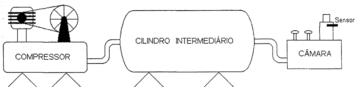
Figura 6.2 – Estrutura utilizada para a medição de v
