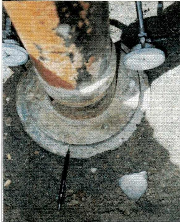
**Figura 3.17 – Afundamento da placa.**
