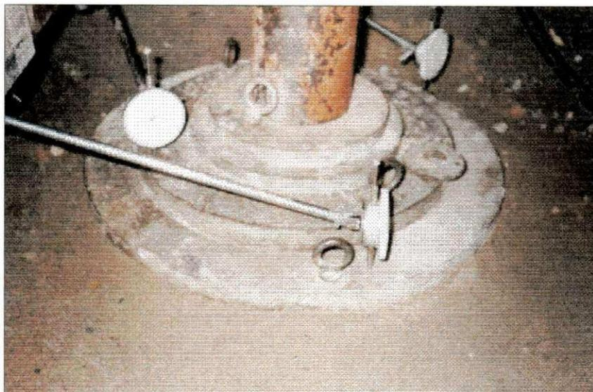
**Figura 3.10 – Primeira prova de carga (PC-1.2).**
