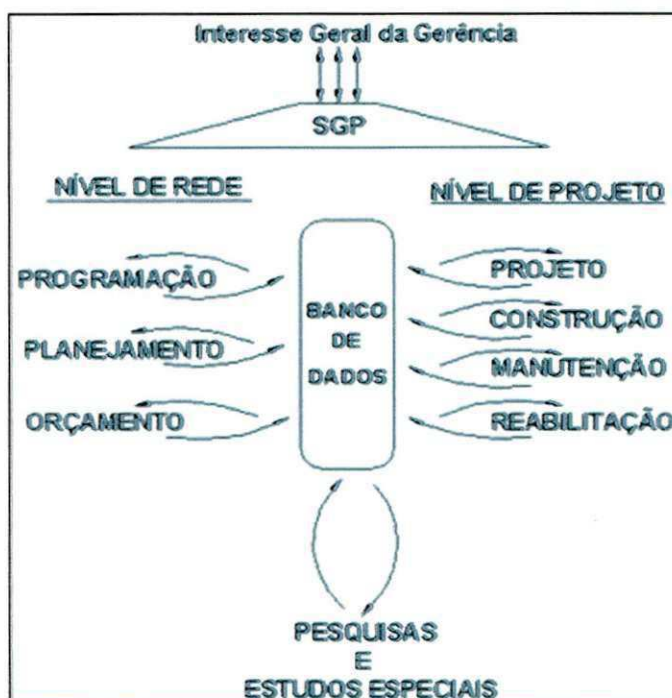
Figura 2.5 - Componentes principais de um Sistema de Gerência de Pavimentos [Fonte: HASS, HUDSON & ZANIEWISKI (1994)].
