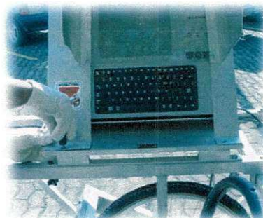
Figura 3.12 - Medidas do Perfil Longitudinal na superfície da Placa, trilha de roda externa com o Perfilógrafo Califórnia.
