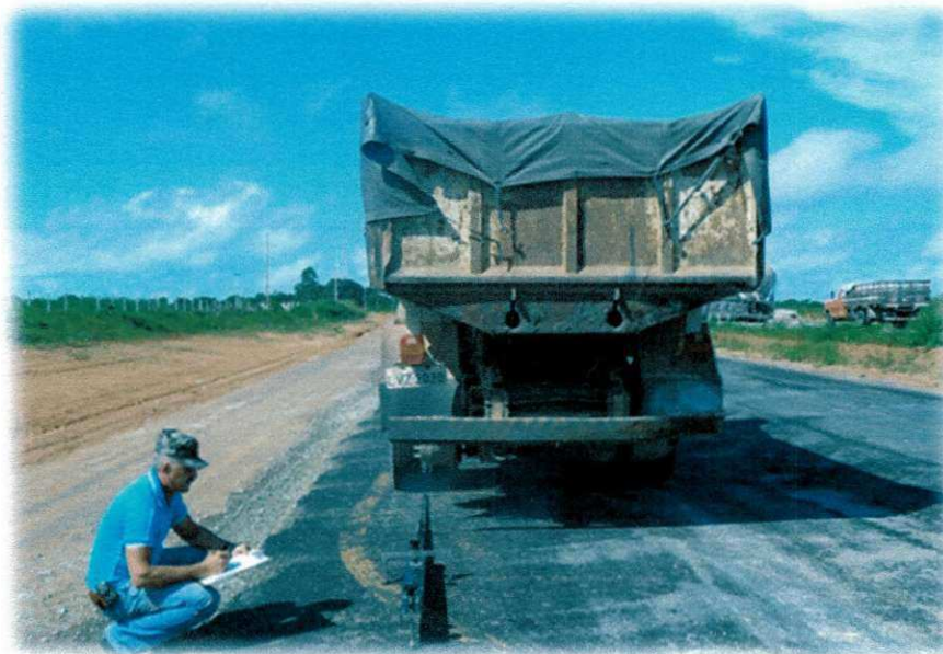
Figura 3.9 - Medidas de Deflexão com a “ viga Benkelman ” na camada de CCR.
