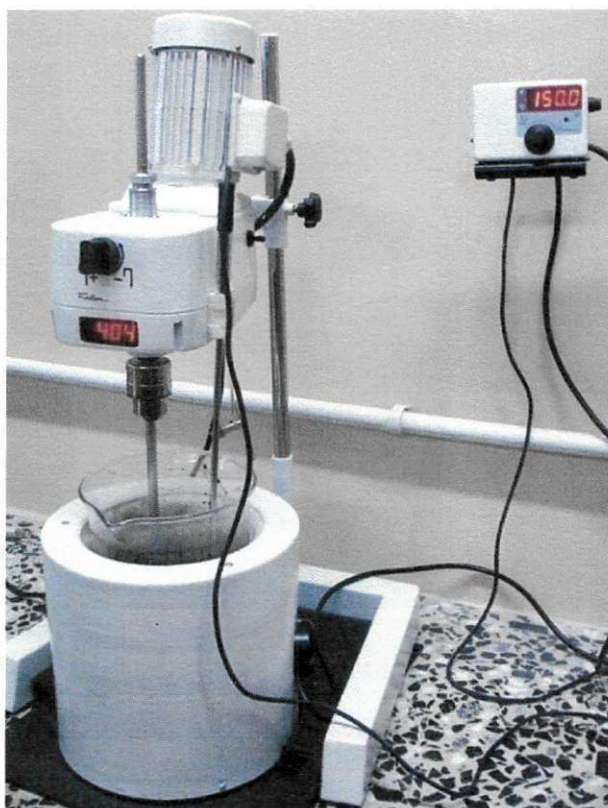
Figura 3.3 – Agitador utilizado para a incorporação dos aditivos às amostras de CAP desta pesquisa do LEP/UAEC/UFCG.
