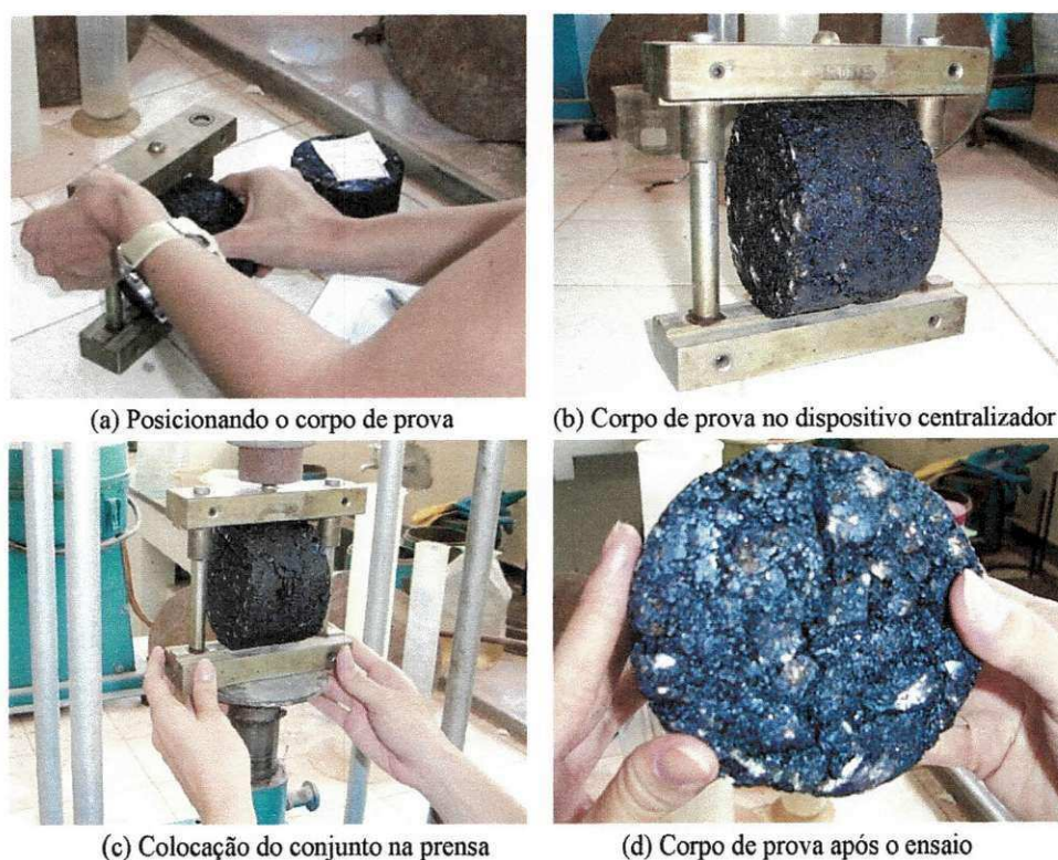
Figura 3.17 – Sequência do procedimento para realização do ensaio de Resistência à tração.
