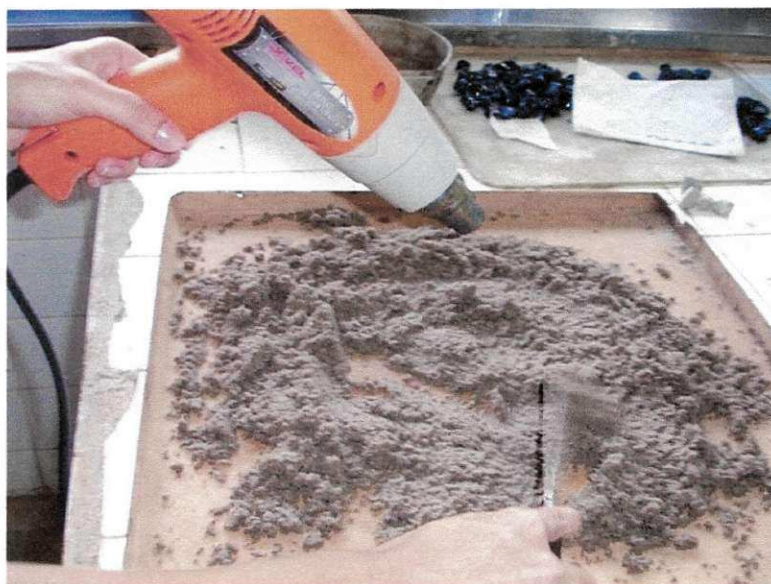
Figura 2.10 – Secador térmico e molde para determinação da absorção do agregado miúdo.
