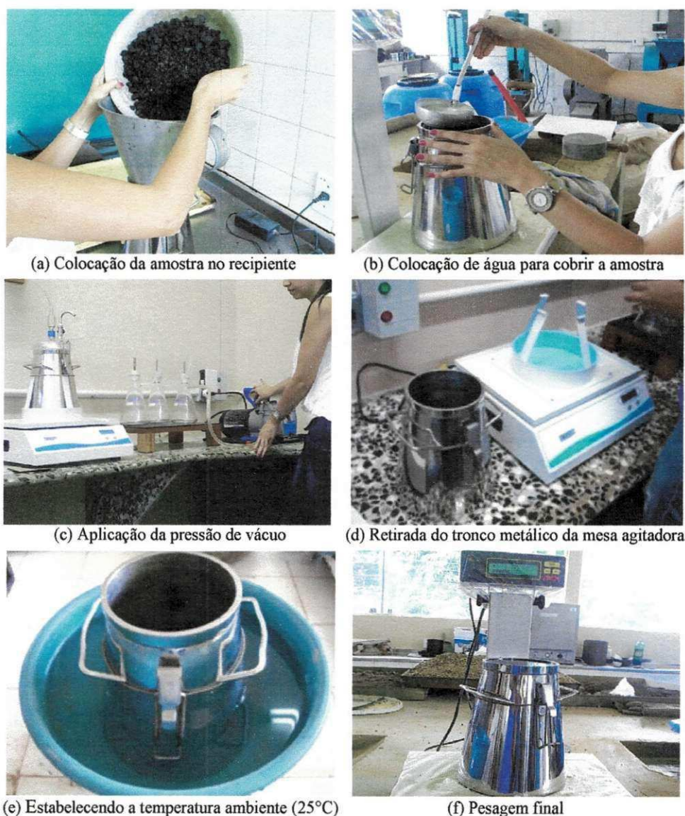
Figura 3.16 – Sequência do procedimento para determinação da Gmm em laboratório.
