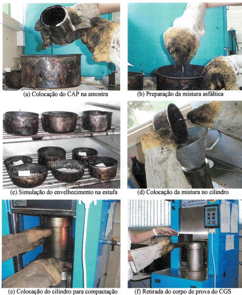
Figura 3.11 – Sequência do procedimento da compactação SUPERPAVE.
