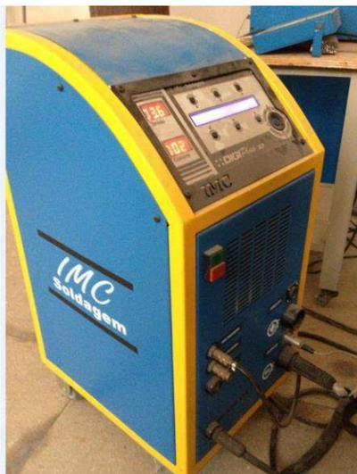
Figura 35 - Fonte de soldagem Digiplus A7 da IMC – Soldagem.
