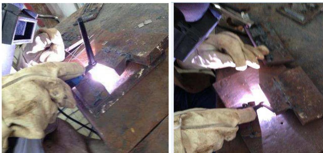
Figura 42 – Soldador realizando a obtenção das juntas NiTi-SS pelo processo GTAW.
