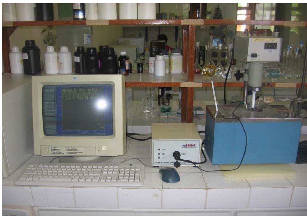
Figura 4: Equipamento usado para eletrodeposição
