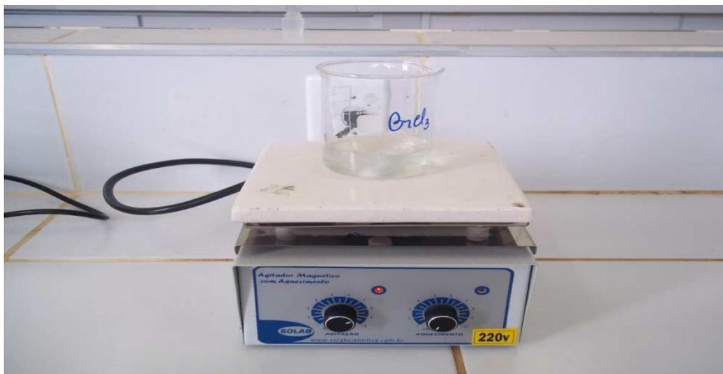
Figura 21 – Solução de  $\text{Cr}_3\text{Cl}$ , tensoativo e a hexano no agitador magnético
