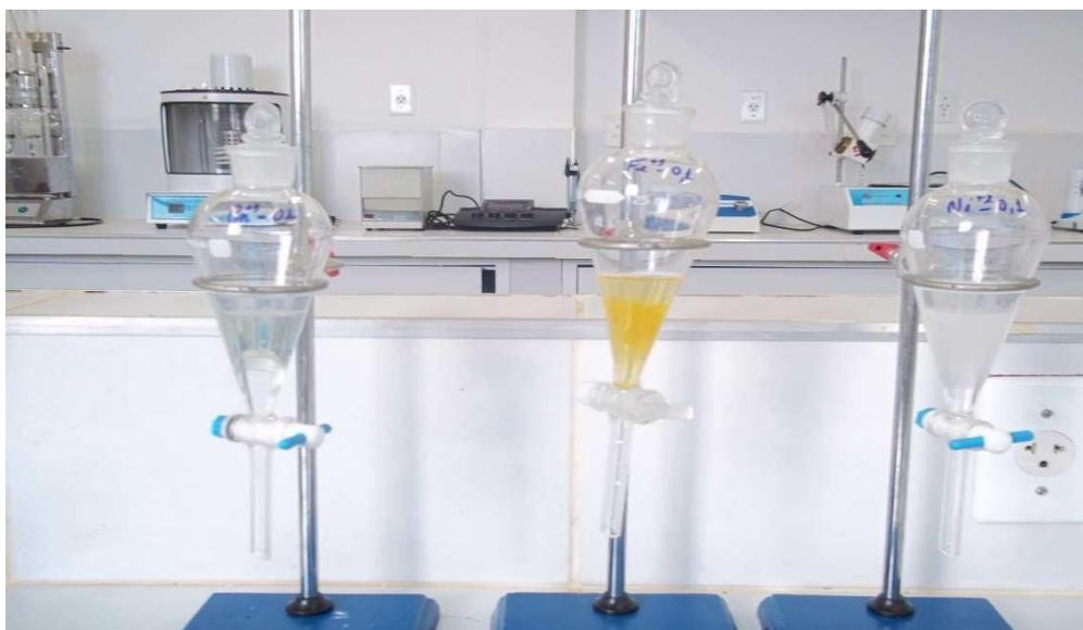
Figura 22 – Separação das fases após o processo de extração dos metais.
