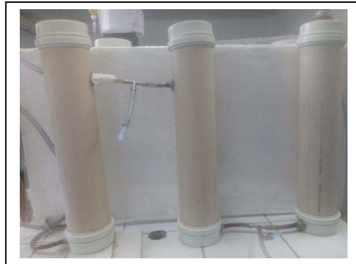
Figura 16 – Série de filtros anaeróbios em escala de bancada.
