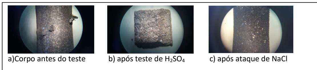
Figura 24 – Corpos Amido-Caulim ataque solução NaCl e H_2SO_4 .
