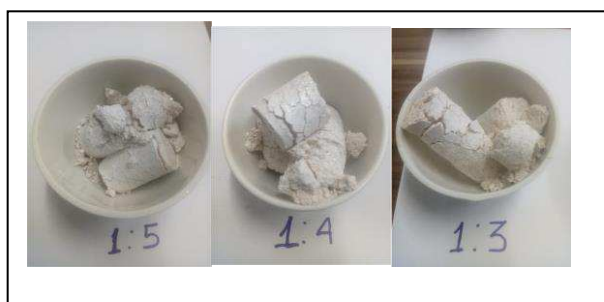
Figura 25 – Corpos Cal-Caulim após queima a 700^\circ C .
