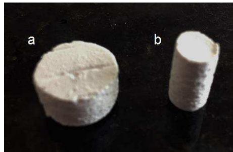
Figura 26: Provetes em forma de pastilha (a) e em forma de cilindro (b) submetidos à síntese hidrotermal de 3h
