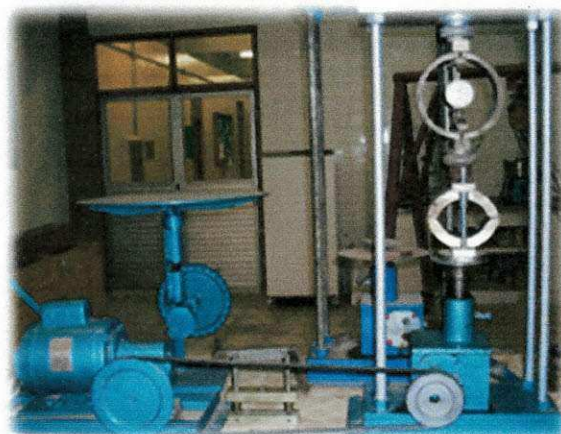
Figura 3.14 - Equipamentos utilizados para realização do ensaio para o rompimento dos Corpos de Prova.
