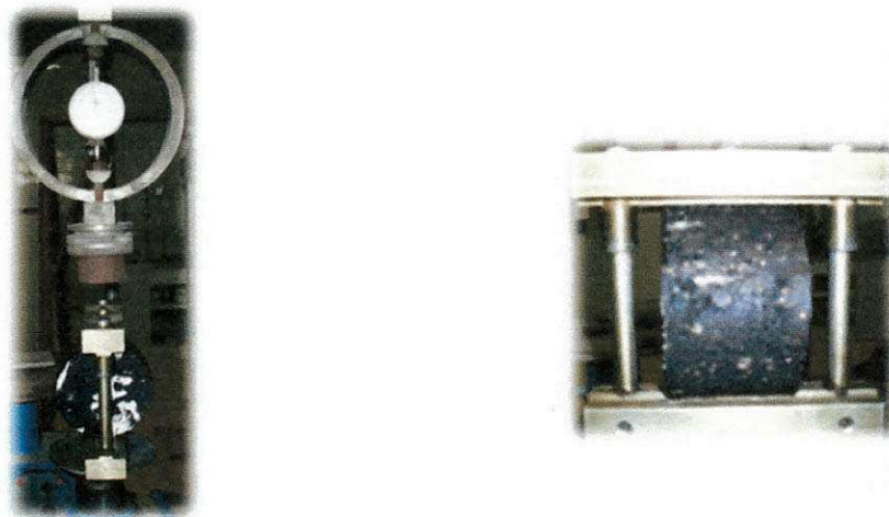
Figura 3.15 - Equipamentos utilizados para realização do ensaio de Resistência a Tração (RT).
