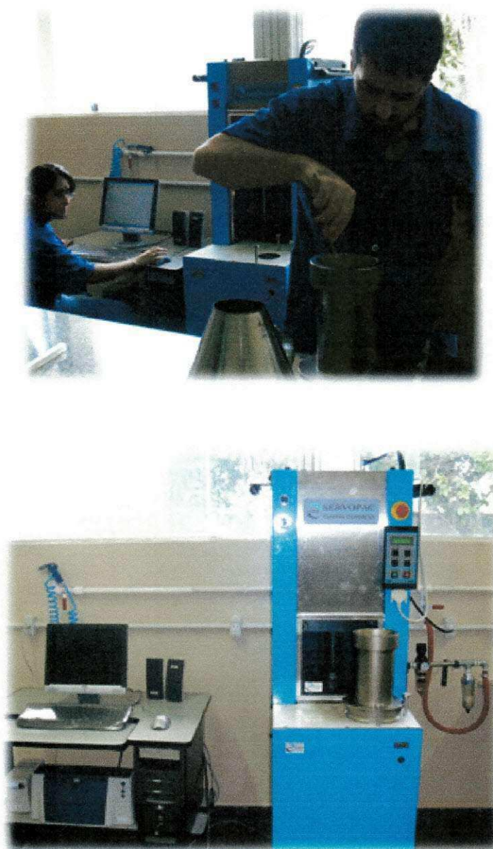
Figura 3.6– Equipamento utilizado para a realização da compactação por amassamento (SGC).
