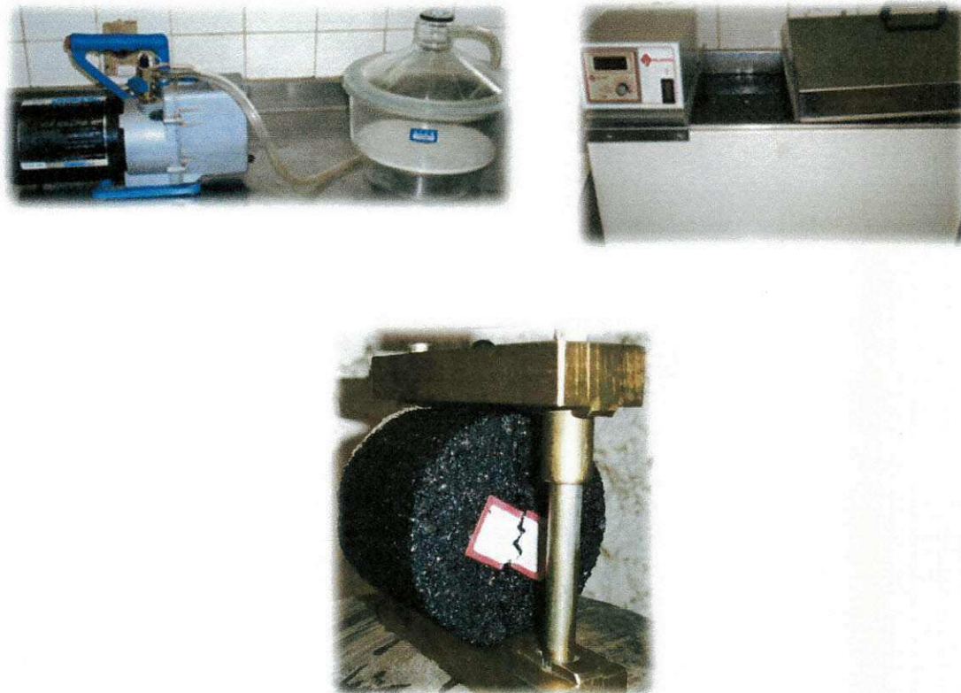
Figura 3.16 - Equipamentos utilizados para realização do ensaio de Lottman Modificado.
