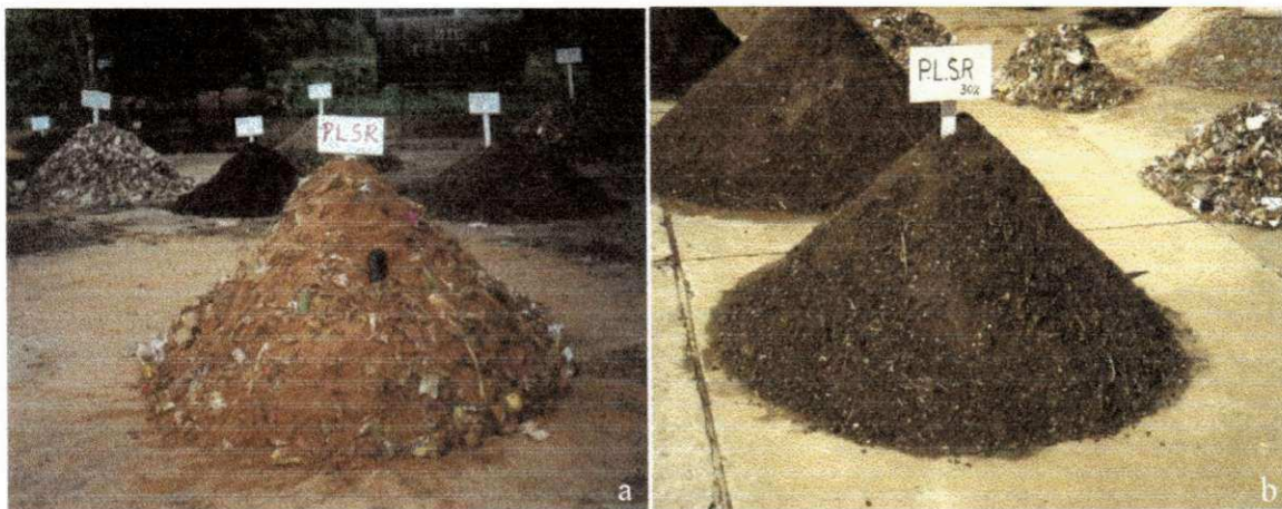
FIGURA 5.22 – Mudança das características da PLSR (30%). (a): pilha no dia 0. (b): pilha no dia 90, após peneiramento.
