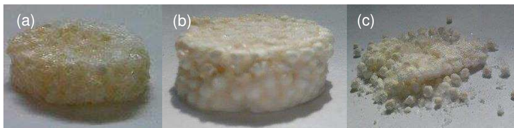
Figura 28- Corpos de prova após ensaio de compressão: (a) QH1 (b) QH3 (c) QH5.
