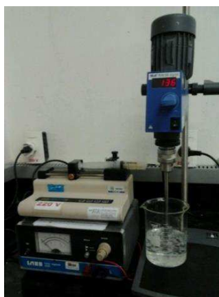
Figura 13- Sistema para formação das esferas de quitosana/hidroxiapatita.
