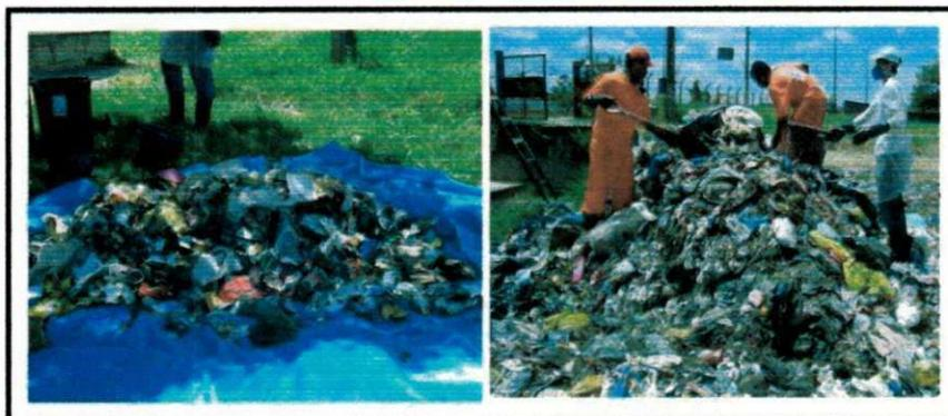
Figura 17. Amostra sendo retirada da pilha para a composição gravimétrica
