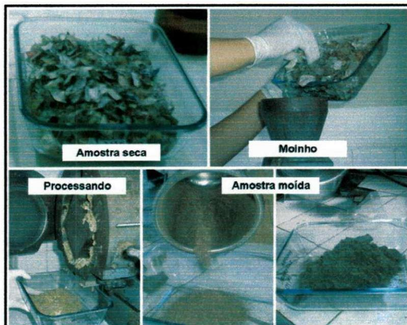
Figura 22. Processamento de moagem da amostra
