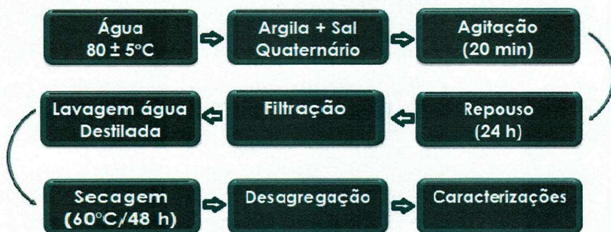
Figura 4. 2: Preparação e obtenção da argila organofílica.
