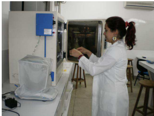
Figura 06: Cadinhos sendo colocados em estufa para posterior fabricação de lâminas permanentes;
