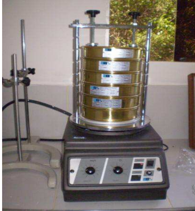
Figura 09: Peneiramento do sedimento através de agitação em máquina de “rot-up”.
