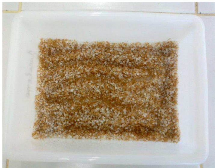
Figura 4 - Resina mista, regenerada com NaCl sólido Fonte - Dados pessoais da pesquisa.
