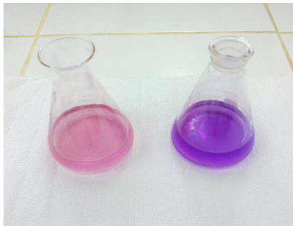
Figura14 - Solução de H 2 O + NaOH + indicador (antes) e Ponto final da Complexação (Ponto de viragem)
