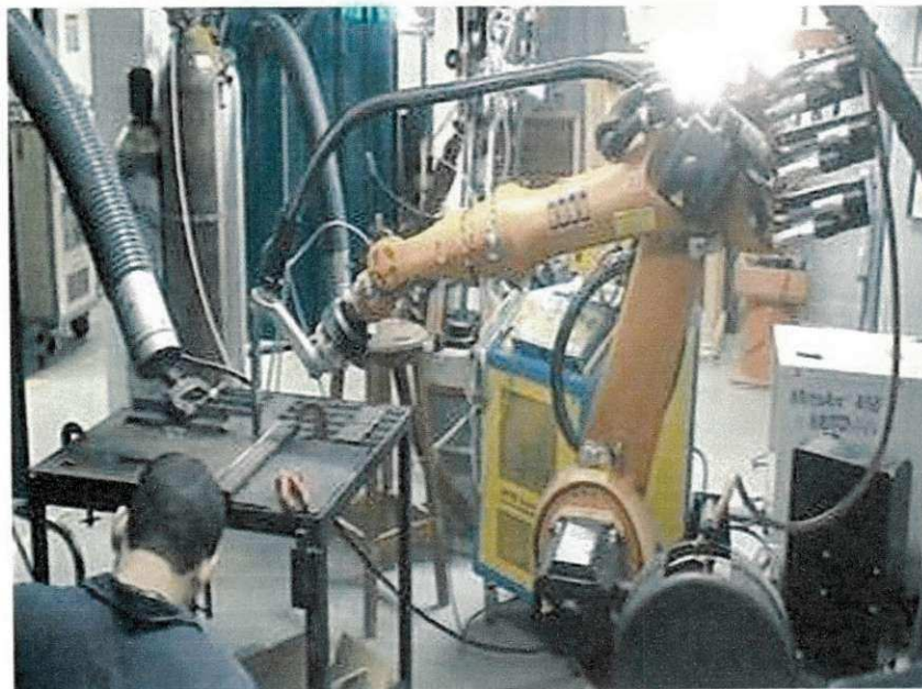
Figura 4.6 - Robô utilizado para a execução de soldagens automatizadas, LRSS-UFMG.
