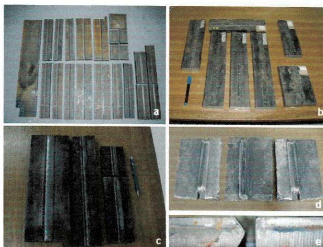
Figura 4.2 –Corte e soldagem do aço API 5L X80 para todos os processos, a) corte da chapa, b) soldagem M1 e M2, c) Soldagem R1, d) soldagem R2, e) Forma do chanfro.
