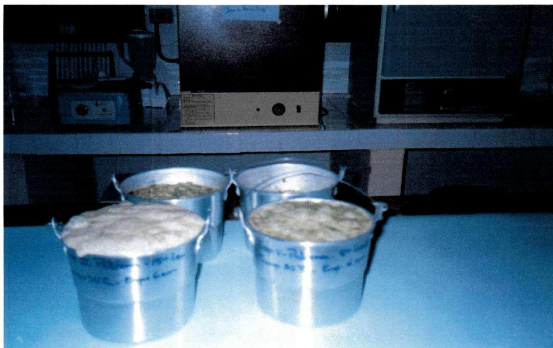
Figura 3.5. Bandejas (biorreatores) utilizadas nos experimentos, contendo substratos inoculados com a levedura em crescimento. (Níveis de espessura da camada de 4 cm e 6 cm).
