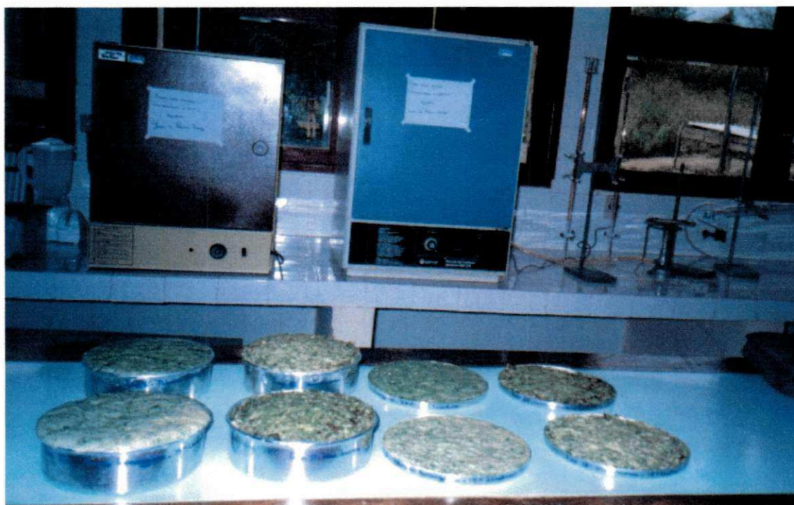
Figura 3.4. Apresenta os reatores para trabalho com espessura da camada de 2 cm. As quatro bandejas da direita foram utilizadas para testes preliminares.
