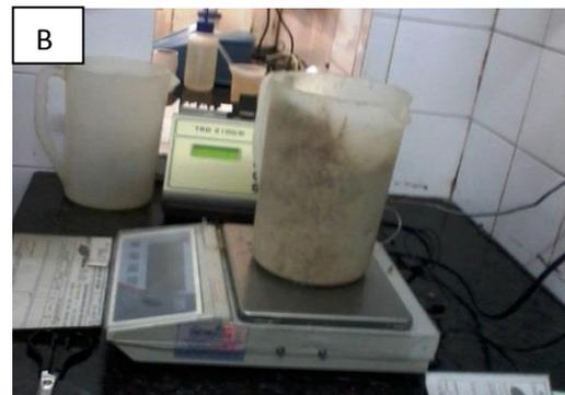
**Figura 6:** 'A', Amostra desintegrada e homogeneizada, pesando 2 kg; 'B' Amostra pesando 0,5 kg, retirada da amostra desintegrada. Santa Rita- PB, 2014.
