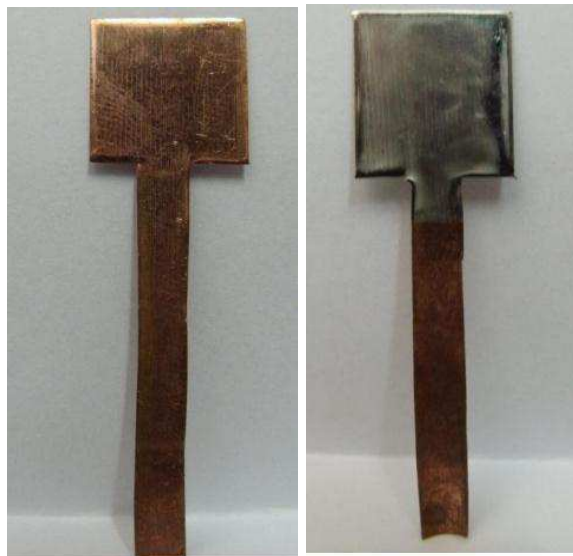
Figura 6: Imagens superficiais do substrato antes e depois do depósito
