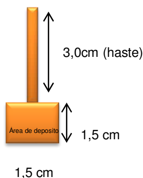
Figura 2: Eletrodo de trabalho (substrato de cobre)
