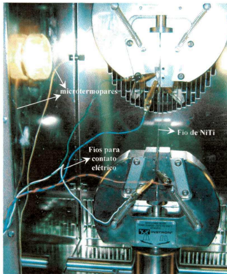
Figura 27: Detalhe da instalação das amostras de NiTi para ensaio de tração acoplado com variação de resistência elétrica.
