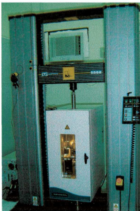
Figura 20: Máquina universal de ensaios Instron 5582 com câmara de aquecimento.
