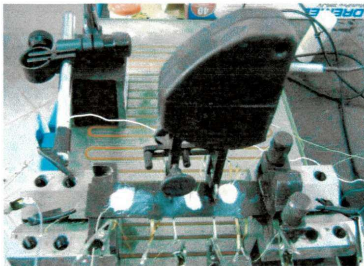
Figura 37: Amostra de CFRP – NiTi sendo ensaiada no teste de dilatação térmica.
