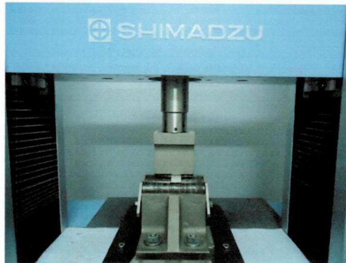
Figura 3.9 - Ilustração do ensaio de flexão a três pontos no equipamento da Shimadzu
