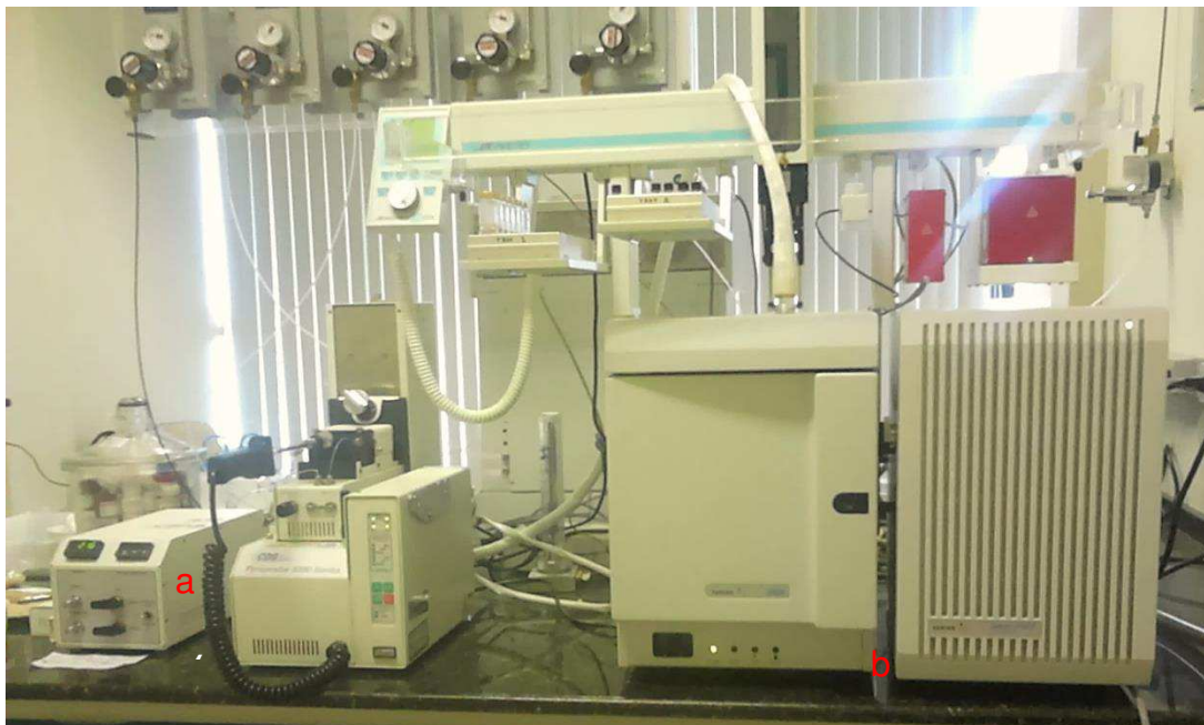
FIGURA 17: (a) pirolisador 5200 HP-R da CDS Analytical e (b) Cromatógrafo GC-EM da Varian.
