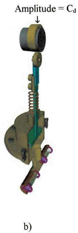
Figura 3.12 - Detalhe da amplitude de uma came. a) Vista frontal; b) Vista em 45°.
