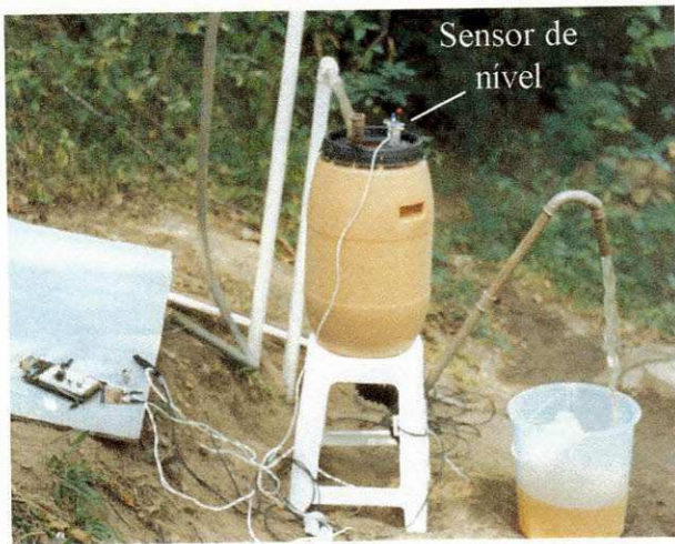
Figura 3.25 – Sistema de medição da água bombeada. a) Vista geral b) Detalhe do sensor da vazão.
