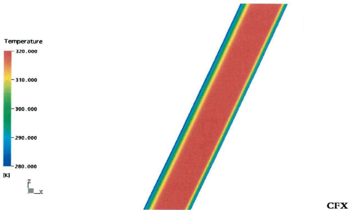
Figura 4.30 – Distribuição da temperatura do óleo na região intermediária da catenária.
