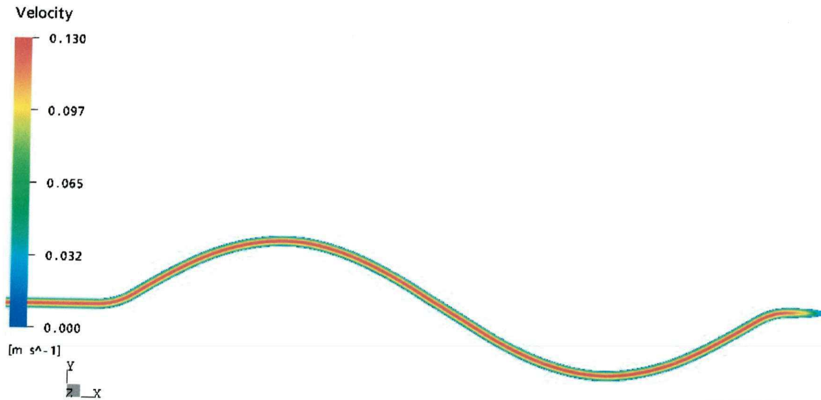
Figura 4.10 – Distribuição da velocidade do óleo na região curva do duto (senóide).
