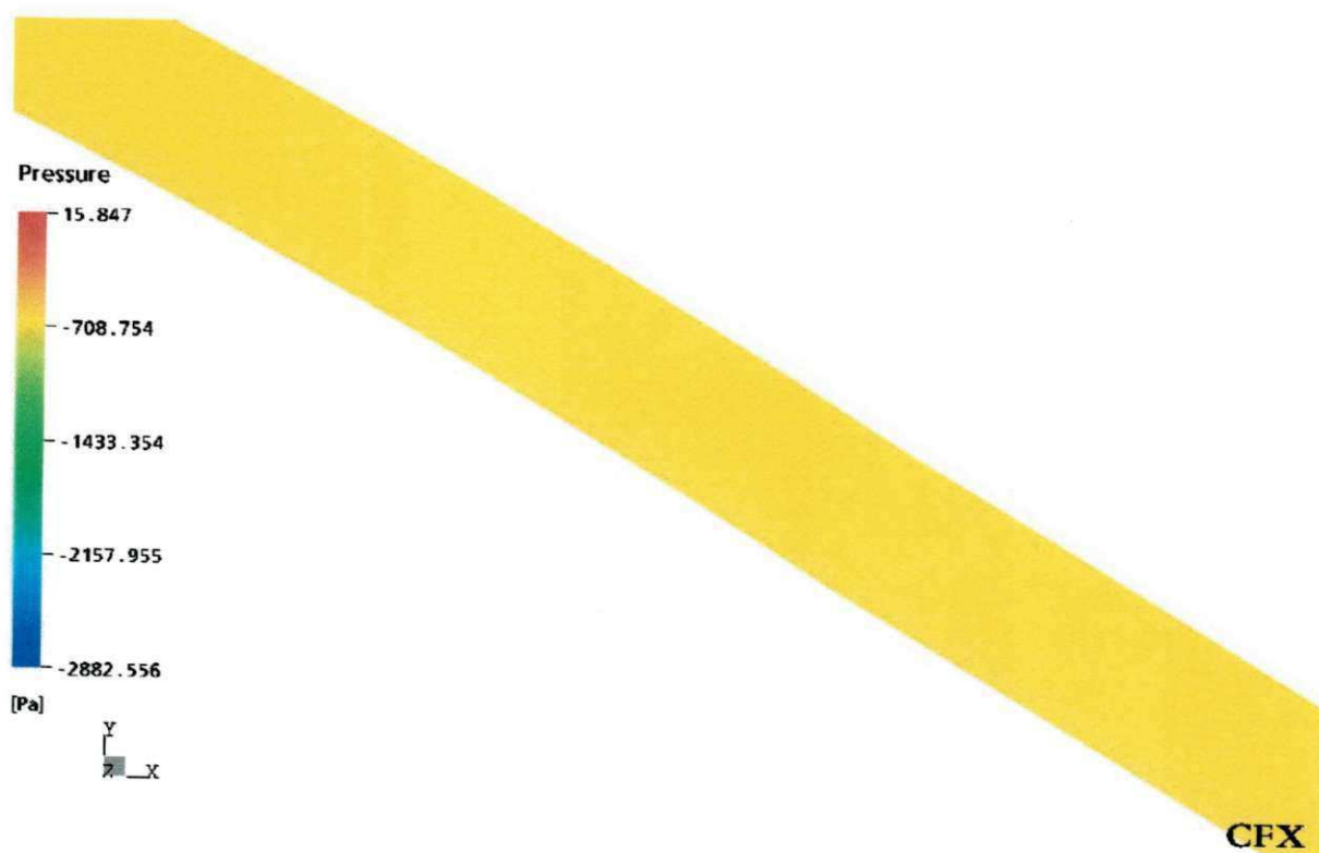
Figura 4.20 – Distribuição da pressão do óleo na região intermediária da senóide.
