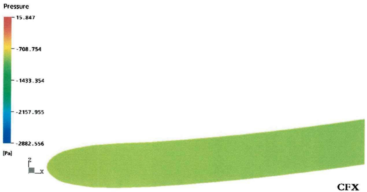
Figura 4.26 – Distribuição da pressão do óleo na região de saída da senóide (plano zx).
