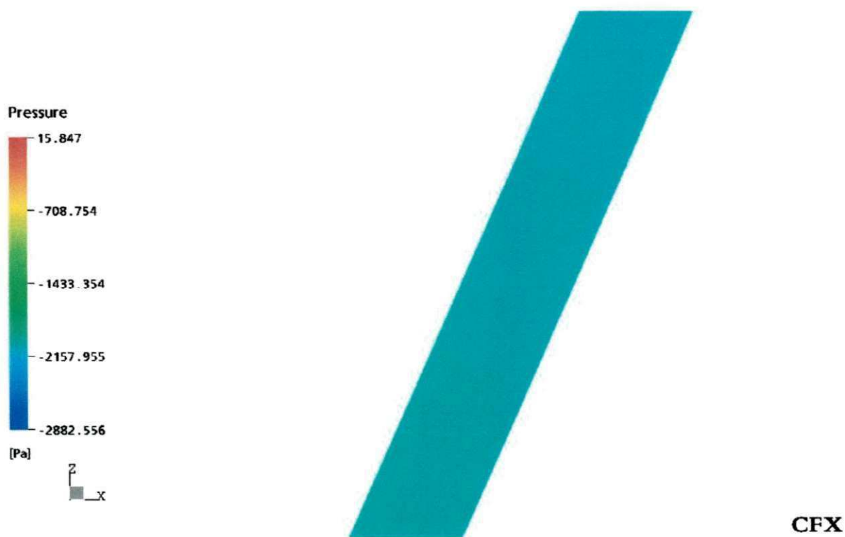
Figura 4.29 – Distribuição da pressão do óleo na região intermediária da catenária
