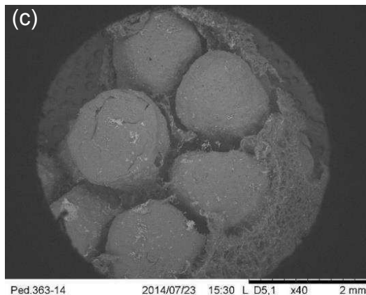
Figura 36 - Micrografias da seção transversal dos arcabouços de (a) quitosana/curcumina (aumento de 100x), (b) (aumento de 120X), (c) da parte externa do arcabouço de quitosana/curcumina (aumento de 40X) e (d) da região de interligação das esferas de quitosana/ curcumina (aumento de 300X).
