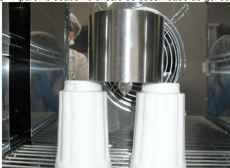
Figura 9 - Aparelho usado no ensaio de coesividade do gel de silicone.
