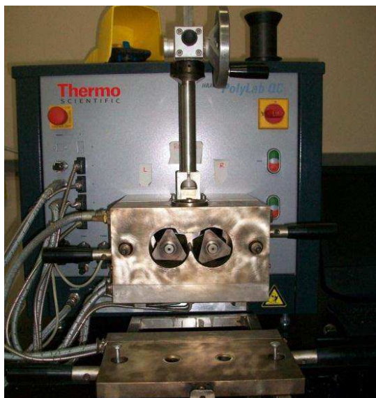
Figura 4.2 - Misturador interno acoplado ao reômetro de torque Haake Rheomix 3000QC da PolyLab QC.
