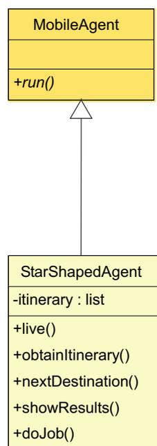
Figura A.11: Diagrama de classes para o padrão *Star-Shaped* na plataforma Aglets.
