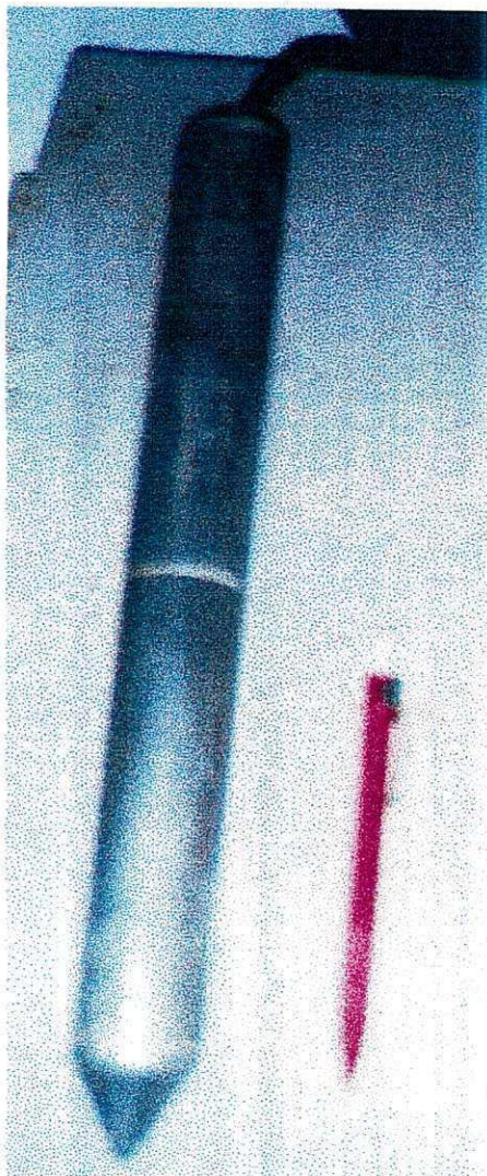
Figura AI.1- Cone elétrico utilizado no presente trabalho.
