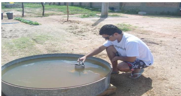
**FIGURA 2:** Tanque evaporímetro “Classe A”. Pombal, PB, 2011
