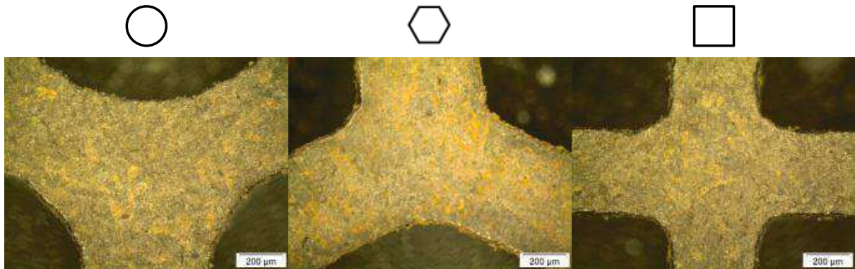
Figura 42 - Avaliação da superfície das telas de LMF Ni-Ti após o processo de laminação a frio.
