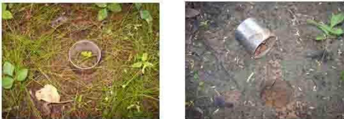
**Figura 3.** Anel metálico utilizado na coleta de amostras indeformadas de solo para determinação da mesofauna edáfica
