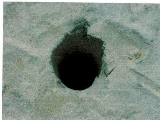
Figura 3.18 - Vista superior do Furo n° 01 - destaque para a regularidade do furo.
