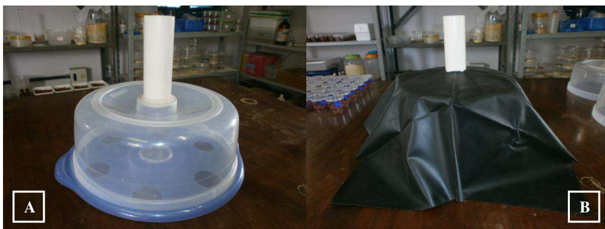
Figura 5. (A) Arena utilizada para determinar a capacidade de repelência dos produtos a Alphitobius diaperinus e (B) arena coberta com tecido preto. Campina Grande, Paraíba, 2013.
