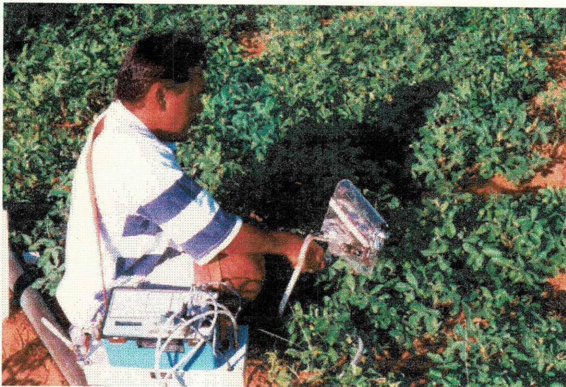
Coleta de dados e informações porométricas utilizando o LI - 6000
