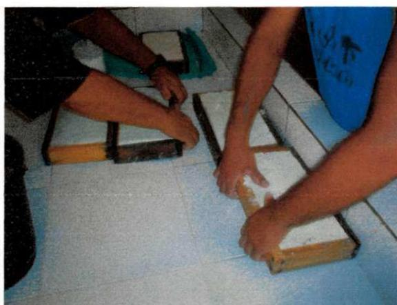
Figura 3 – Prensagem manual em prensas de madeira de formato retangular.
