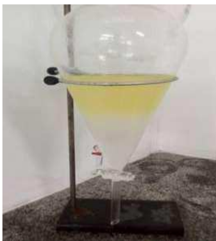
Figura 15 – Representação da purificação do biodiesel por lavagem.
