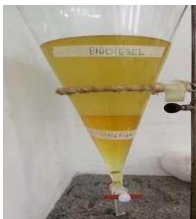
Figura 14 – Separação das fases mais leve (biodiesel) e mais densa (glicerina).
