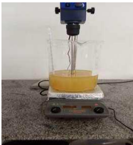
Figura 13 – Sistema utilizado na síntese do biodiesel via transesterificação.
