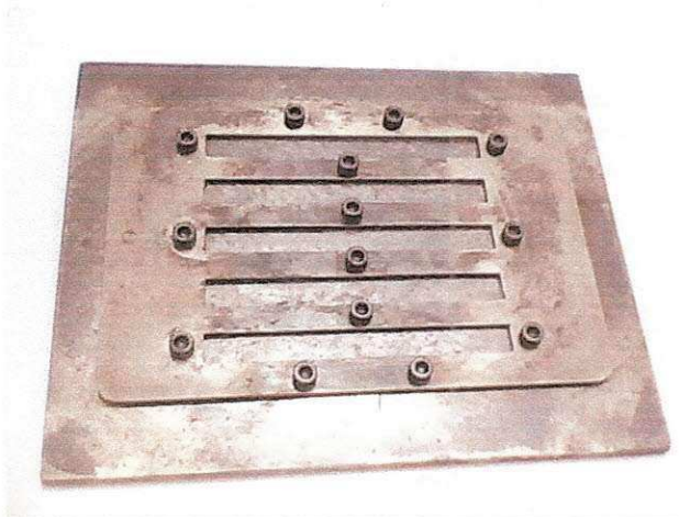
Figura 4.3. Molde metálico confeccionado com cavidades retangulares de 125,0x12,7x3,2 mm correspondentes ao formato de corpos de prova tipo flexão (ASTM D790).
