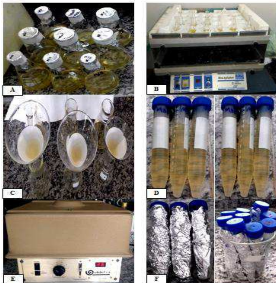
A: Amostras de mel em erlenmeyers; B: Mesa agitadora; C: Filtração dos extratos de mel; D: Tubos Falcon ; E: Centrífuga e F: Tubos Falcon envolto em papel alumínio.
