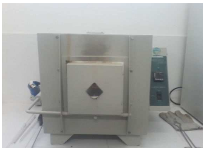
Figura 10. Mufla utilizada durante o processo de compostagem para determinação dos sólidos voláteis.
