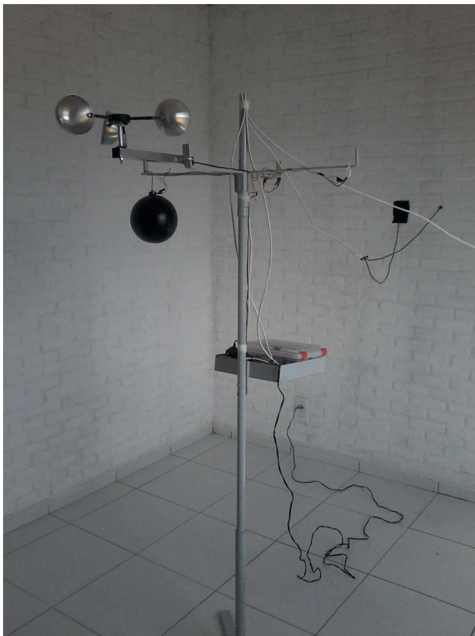
Figura 18 - Estação meteorológica composta de arduíno tipo Mega e sensores para obtenção e dados de temperatura, umidade e velocidade do vento
