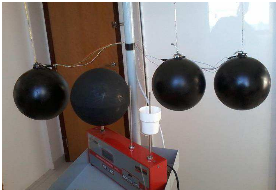
Figura 21 - Aferição dos globos negros
