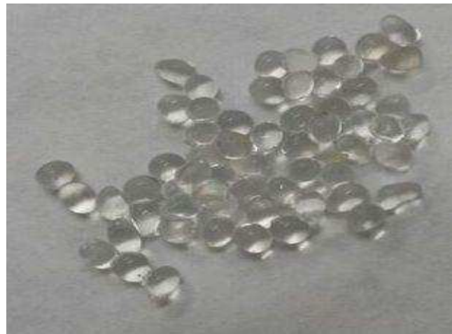
Figura 9 - Partículas de alginato de sódio ativadas com glutaraldeído 2,5% (v/v)
