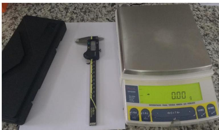
**Figura 18:** Paquímetro digital e balança eletrônica de precisão.
